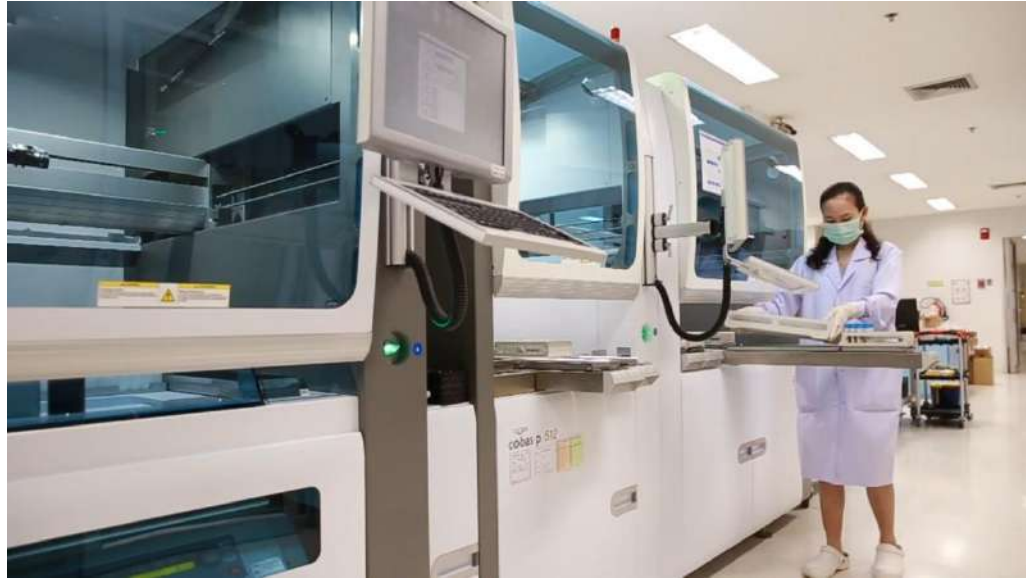
เครื่องวิเคราะห์หัตถ์อัตโนมัติ (Walk away Automated Real Time PCR)
