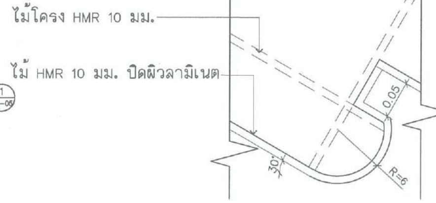
แบบขยาย 1 1:5 หมายเหตุ 1. X = ตรวจสอบระยะจากพื้นจริง 2. สักรวบรวมละเอียดพื้นที่จริงก่อนดำเนินการ
