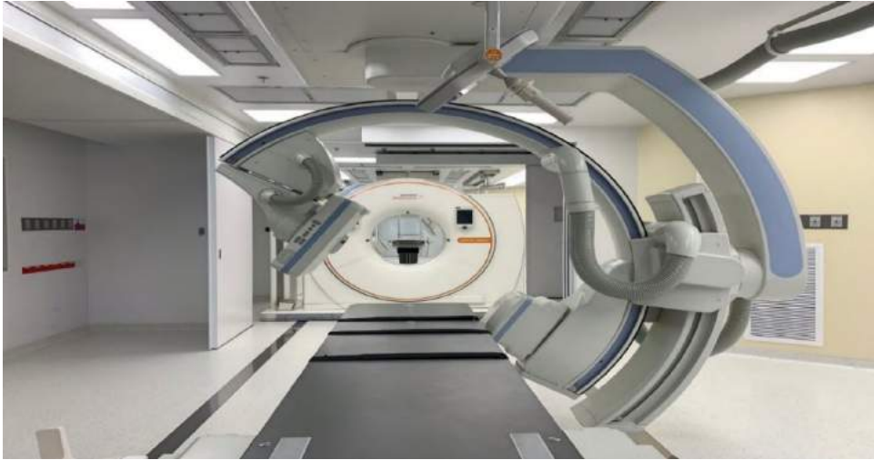
ภาพ เครื่องเอกซเรย์หลอดเลือดระบบไฮบริดซีทีและเอกซเรย์คอมพิวเตอร์ระบบไฮบริดซีทีหือ Siemens รุ่น Nexaris Angio-CT
